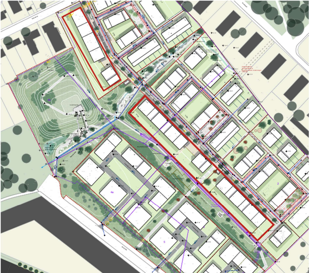
Abbildung 9: Lärmschutzriegel (rote umrandete Flächen), (Quelle: QF 1)
