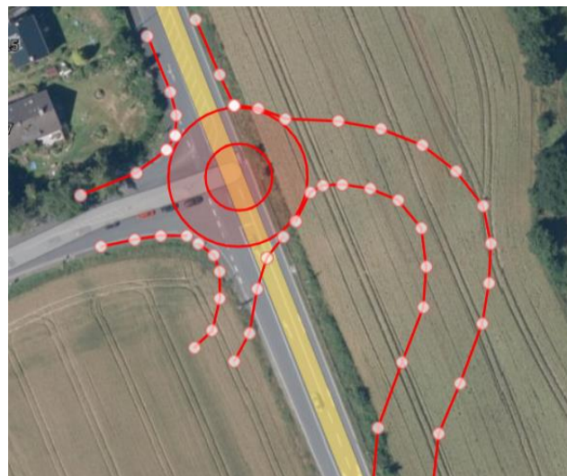
Abbildung 22: Prinzipskizze 4-armiger Kreisverkehr (unmaßstäblich, ohne techn. Prüfung)
