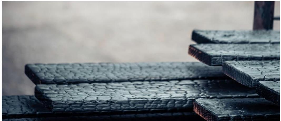
Langlebige Schönheit durch die Urgewalt des Feuers. Das Feuer zerstört die Holzoberfläche nicht, sondern veredelt und konserviert sie. Die Zellen im Holz verdichten sich und machen es resistent gegen Schimmel, Verwitterung, Insekten- und Pilzbefall.
