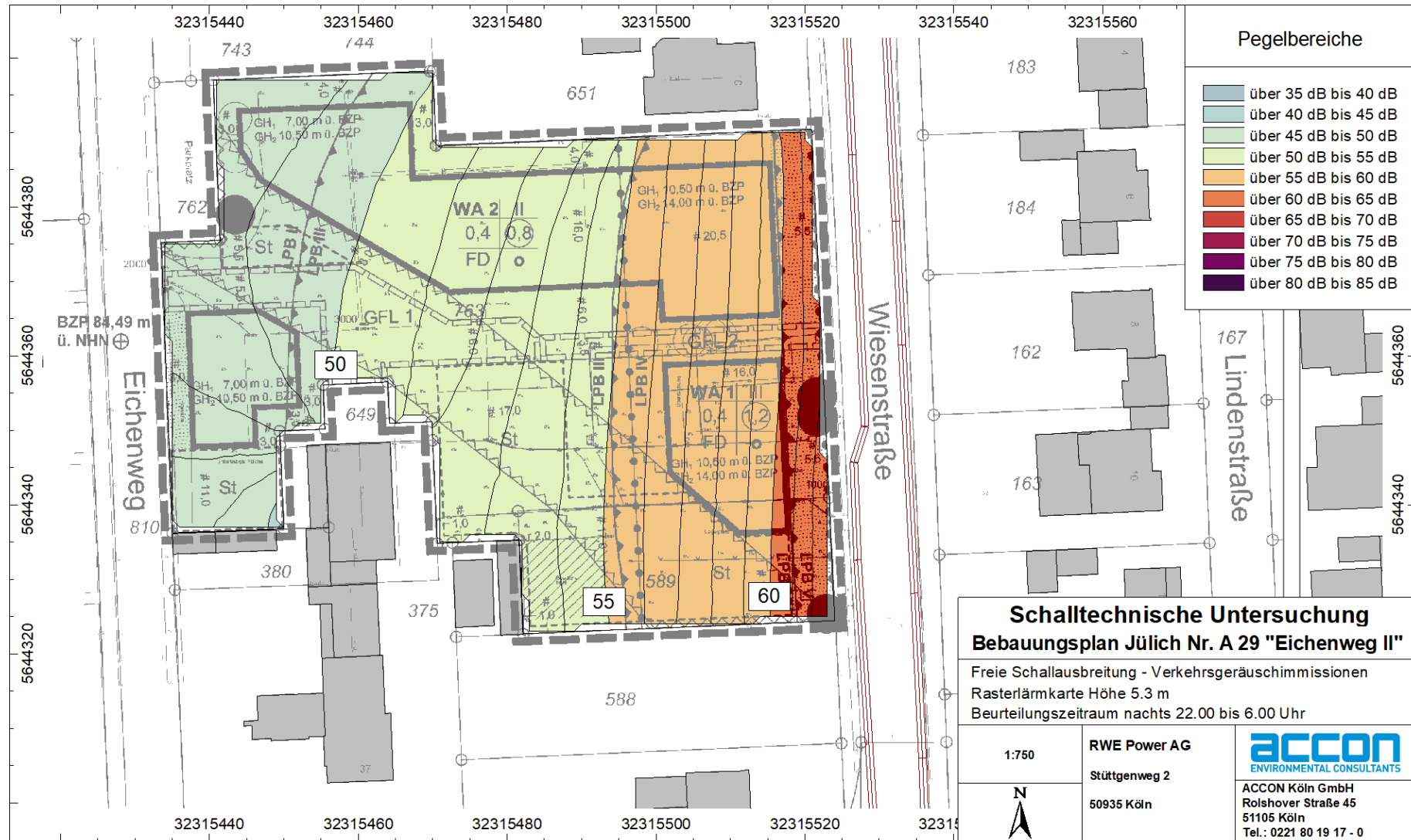
Abb. 4.2.6 Verkehrsgeräuschimmissionen im Freifeld in einer Höhe von 5,3 m (1.OG) über Grund, nachts
