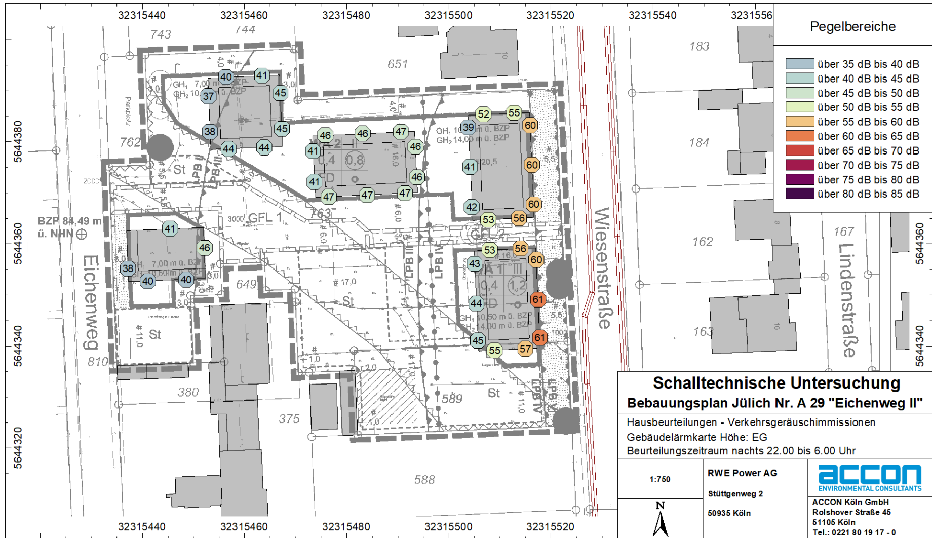
Abb. 4.2.13 Verkehrsgeräuschmissionen in Form einer Gebäudelärmkarte für die geplante Bebauung in der Höhe des EG nachts
