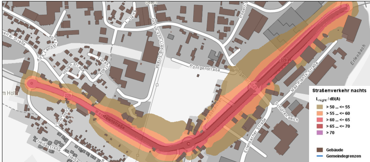
Abbildung 14: 1. Detailansicht Lärmprobleme an Gebäuden im östlichen Stadtgebiet (Nacht-Schallpegel L_{night} 60 dB(A) und höher an der Gebäudefassade)
