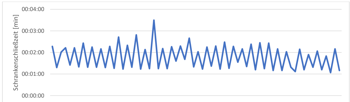
Bild 11: Schrankenschließzeiten am BÜ Dürener Straße (Quelle: Rurtalbahn GmbH)
