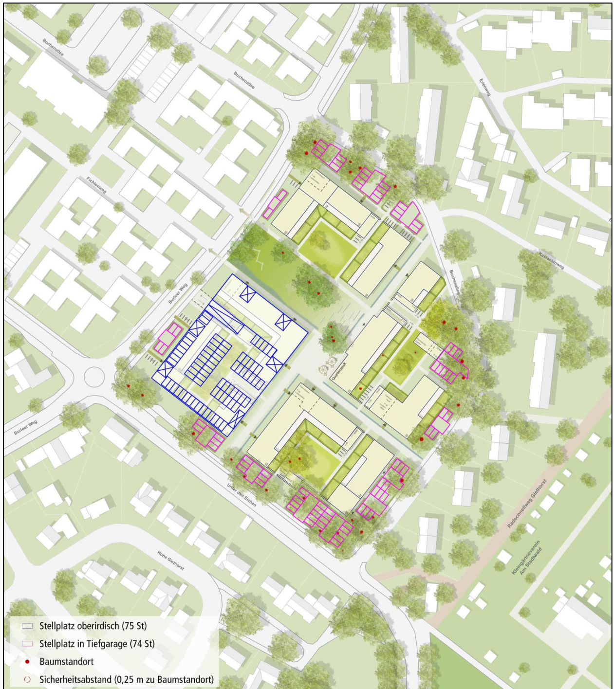
Abbildung 14: Entwurf der Stellplätze des Wohnquartiers „Wohnen am Stadtwald“ [Quelle: farwick + grote, Stand: 05.10.2023]
